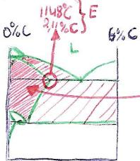
• Austenita: es la solución sólida por inserción de los átomos del carbono en los huecos intersticiales octaédricos de hierro  $\gamma$  (FCC). Los átomos del C no ocupan totalmente por lo que distorsionan la red cristalina, de forma que a 1148°C se consigue la solubilidad máxima de 2,11%, punto E.
