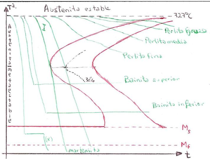
Para una aleación eutéctoide, a temperaturas ligeramente inferiores a la eutéctoide, se necesita un tiempo muy elevado para que se complete la transformación.
