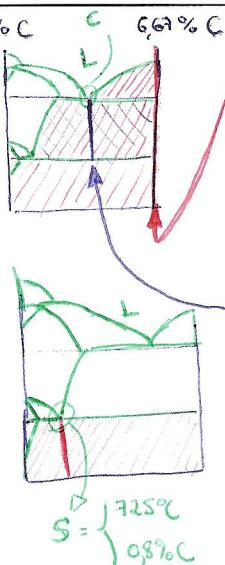
Cementita: compuesto intermetálico (con enlaces metálicos y no metálicos, aunque con carácter global metálico) cuya composición es del 6,67% C y responde a  $\text{Fe}_3\text{C}$ . Cristaliza de forma ortorrombica y es el más duro y frágil de los constituyentes de los aceros.
