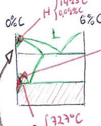
• Ferrita  $\alpha$ : solución sólida de inserción de átomos de C en los huecos intersticiales del hierro  $\alpha$  (BCC) octaédricos. La diferencia de radios provoca que exista una gran distorsión de la red, generando una escasa solubilidad que alcanza el máximo a 0,0218% C con una  $t^*$  de 727°C, por lo que se considera hierro puro, siendo el más blando y dúctil de los aceros, punto P.
