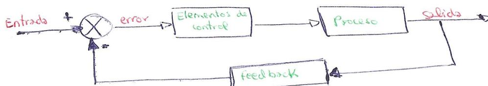
El error, o las diferencias entre los valores de entrada y los de salida, actúa sobre los elementos de control intentando reducirse a cero y alcanzar el valor correcto.
